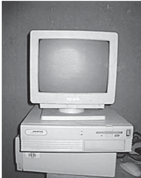
Computadora con procesador 486, antecesor del Pentium de Intel, que corría a 66 Mhz y tenía 4 Mb de RAM.
